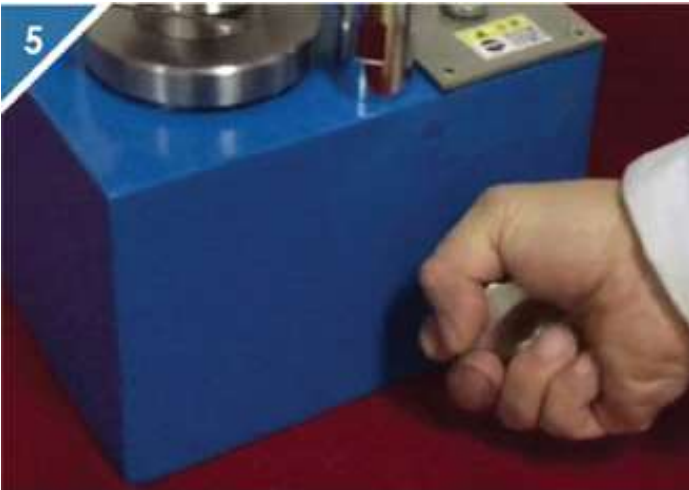
5、逆时针松开放油阀门，释放压力。
