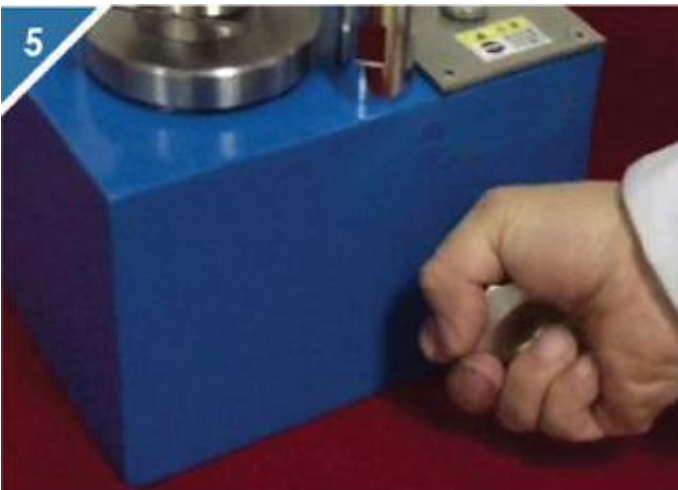
5、逆时针松开放油阀门，释放压力。
