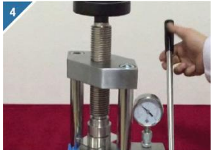
4、上下摇动压机手柄，达到所需压力。
