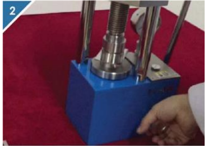
2、顺时针拧紧压片机放油阀门。
